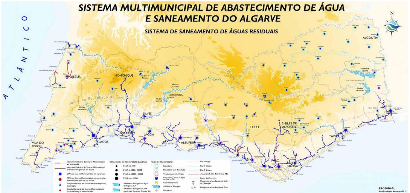
O Sistema de Saneamento de Águas Residuais (SSAR) permite recolher, tratar e devolver ao meio ambiente as águas residuais tratadas nas ETAR que integram a concessão.
