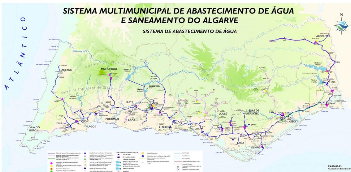
O Sistema Multimunicipal de Abastecimento de Água e Saneamento do Algarve (SMAASA) tem a concessão para a captação, tratamento e adução de água, em alta, para a garantia do abastecimento público de água à região do Algarve., assegurando elevados níveis de qualidade, mediante a implementação de tecnologias avançadas de tratamento e com um rigoroso controlo e monitorização dos processos.
