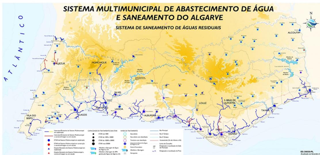
O Sistema de Saneamento de Águas Residuais (SSAR) permite recolher, tratar e devolver ao meio ambiente as águas residuais tratadas nas ETAR que integram a concessão.
