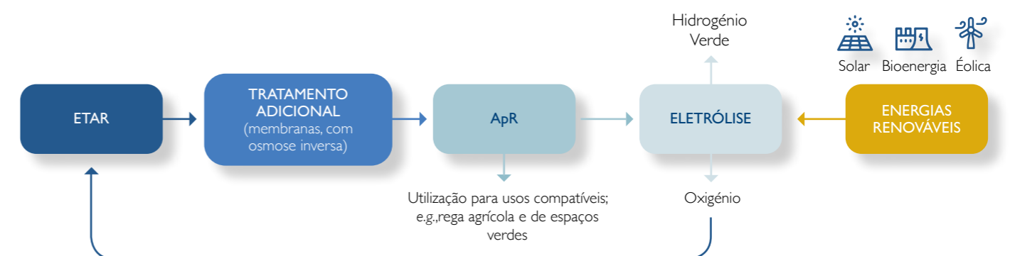
FIGURA 1: Representação esquemática simplificada da produção simultânea de ApR e de hidrogénio verde num sistema de tratamento de águas residuais numa perspetiva de médio-longo prazo
